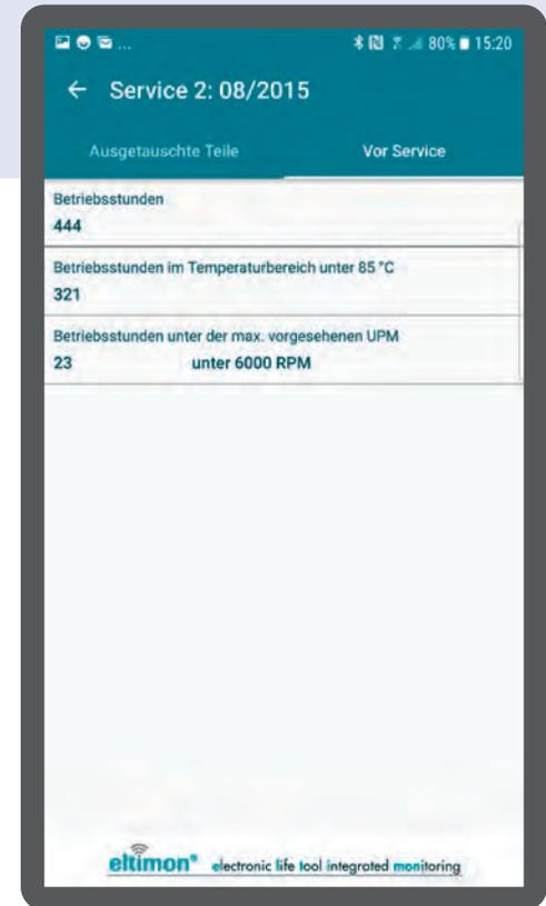
Vor dem Service 2 sind insgesamt 444 Betriebsstunden angefallen. Davon 321 Stunden im Temperaturbereich unter 85 °C und nur 23 Stunden unterhalb der Nenndrehzahl.
