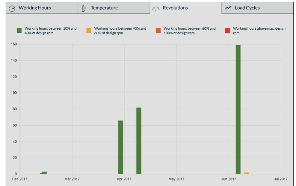
Die Betriebszeiten sind im Drehzahlbereich zwischen 10 und 40 % der Nenndrehzahl angefallen. Nur 2 Stunden im Bereich zwischen 40 und 60 % der Nenndrehzahl. Natürlich findet der Nutzer in der eltimon Cloud auch alle anderen werkzeug-bezogenen Daten, die mit der App ausgelesen wurden.
